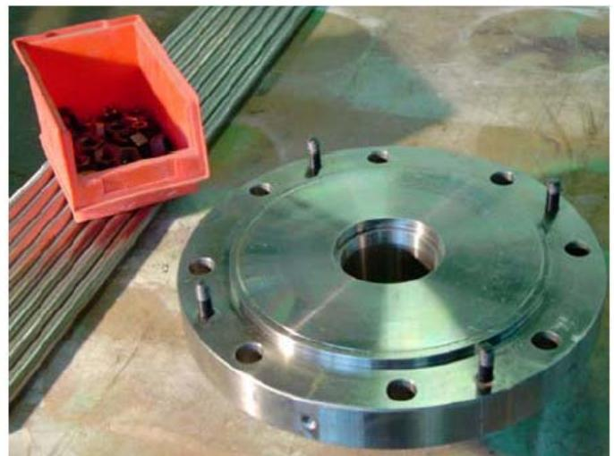
Демонтированный входной корпус
